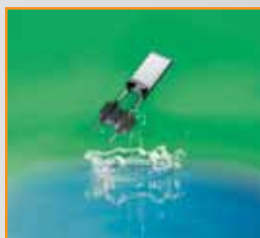
testo的湿度传感器：具有防结露结构及长期的稳定性，符合国际标准（LAC / PTB / NIST等等）
